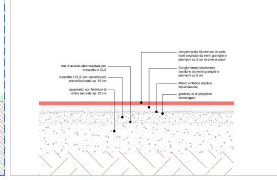
DETAGLIO PAVIMENTAZIONE CAMPO MULTISPORT IN ASFALTO COLORATO - Scala 1:10 - Riferimento CME: R-B5.3
