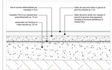
Dettaglio pavimentazione antitruo in gomma - Scala 1:10
