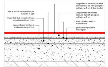
Dettaglio pavimentazione in asfalto colorato - Scala 1:10
