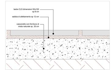
Dettaglio pavimentazione in lastre di cls - Scala 1:10
