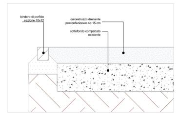
Dettaglio pavimentazione in calcestruzzo drenante - Scala 1:10
