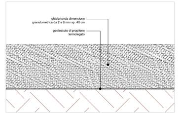
Dettaglio pavimentazione antitruo in ghiaia tonda - Scala 1:10
